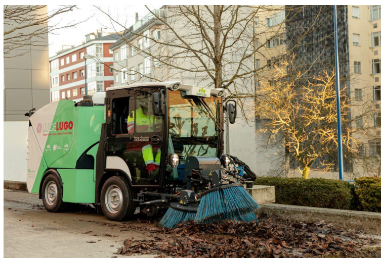
Fig. 11. Barrido mecánico de calles Fuente: EcoLugo
